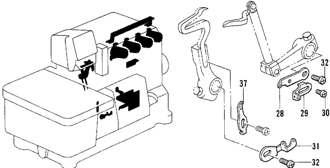
K. 糸調子関係 / Thread tension/Faderspannung/
