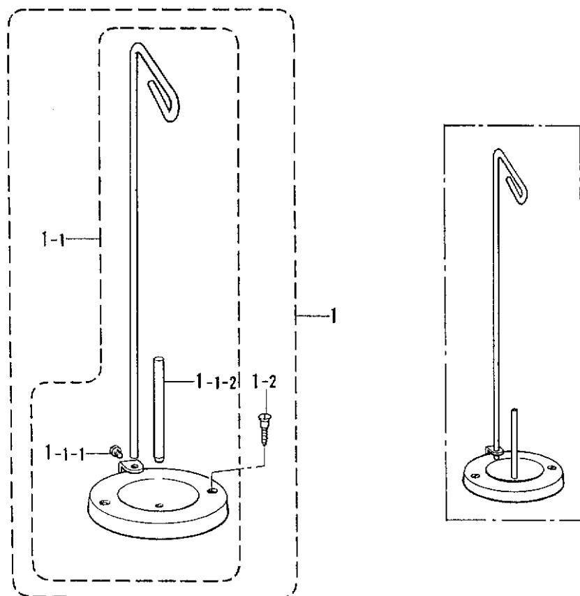
L. 針冷却装置/Needle cooler/Nadelkühlungsvorrichtung/
