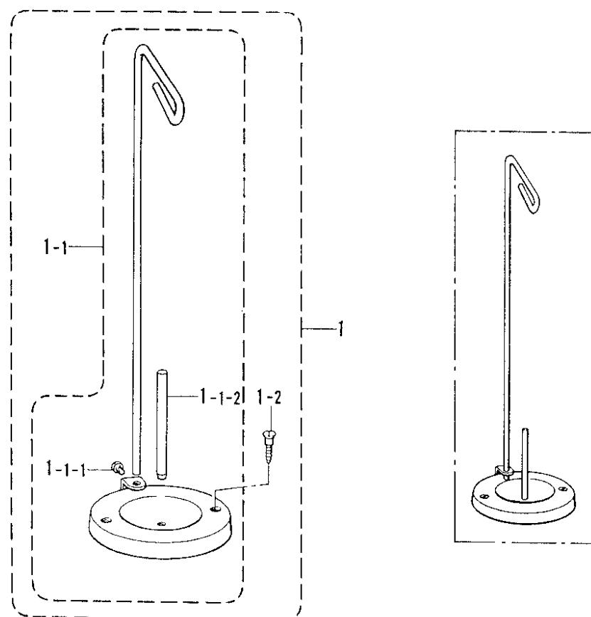
L. 針冷却装置 /Needle cooler/Nadelkühlungsvorrichtung/
