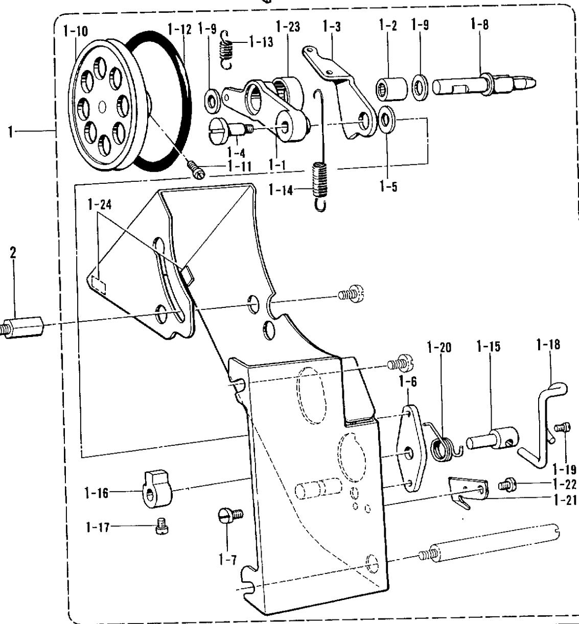
M. 糸巻キ関係 <B772> / Bobbin winder mechanism <B772> / Spuler <B772> /
