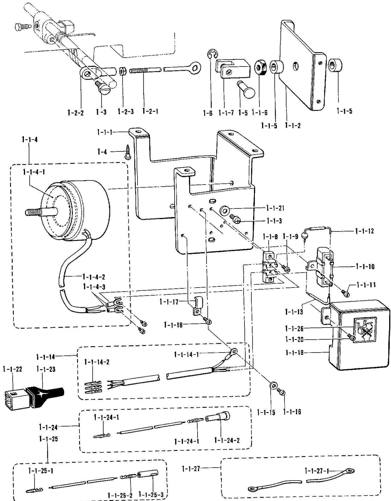
**W1. 電磁押工上ヶ関係 / Presser foot lifting solenoid set / Solenoidsatz für die Anhebung des Stoffdrückerfußes /
