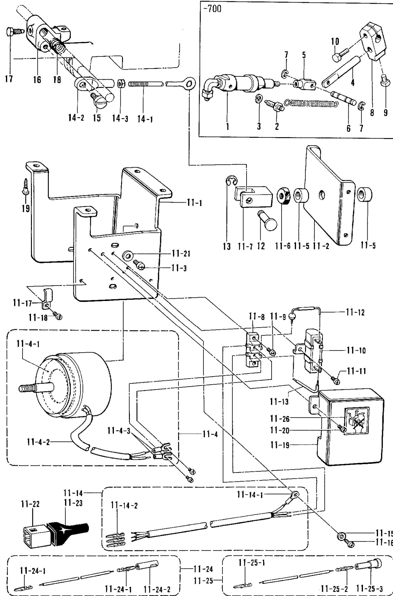
G. 押工上ヶ関係 / Work clamp lifter mechanism / Stoffhalterhebervorrichtung /
