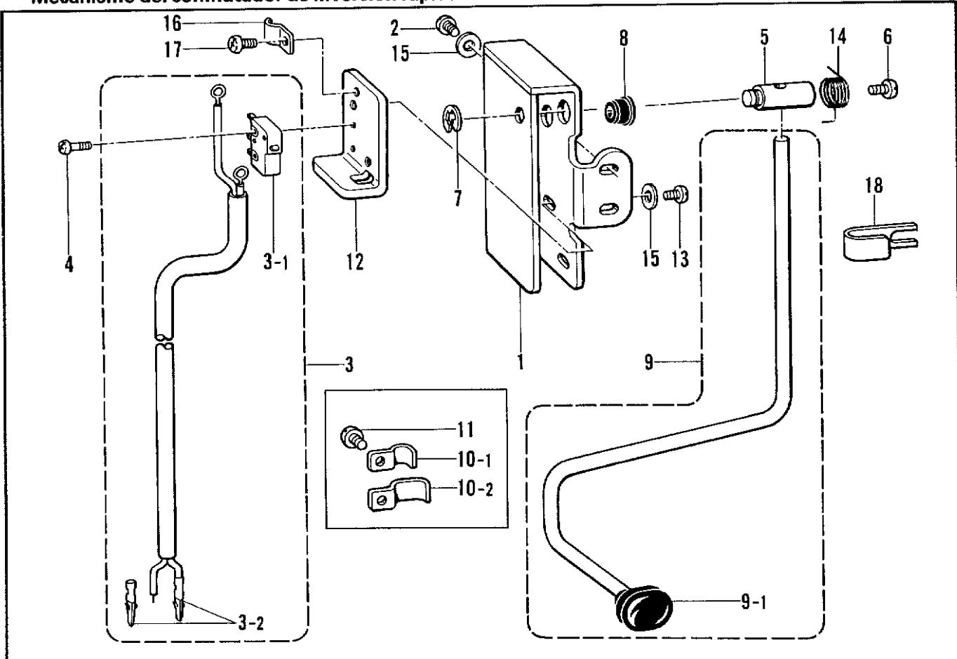
T. ヒザスイッチ関係 <B772> / Knee switch mechanism <B772> / Knieschalter <B772> /
